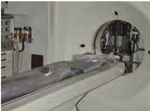
[Figuur 28a.] CT toestel met de patiëntentafel en opening of gantry waarin het te onderzoeken lichaamsdeel geschoven wordt.
